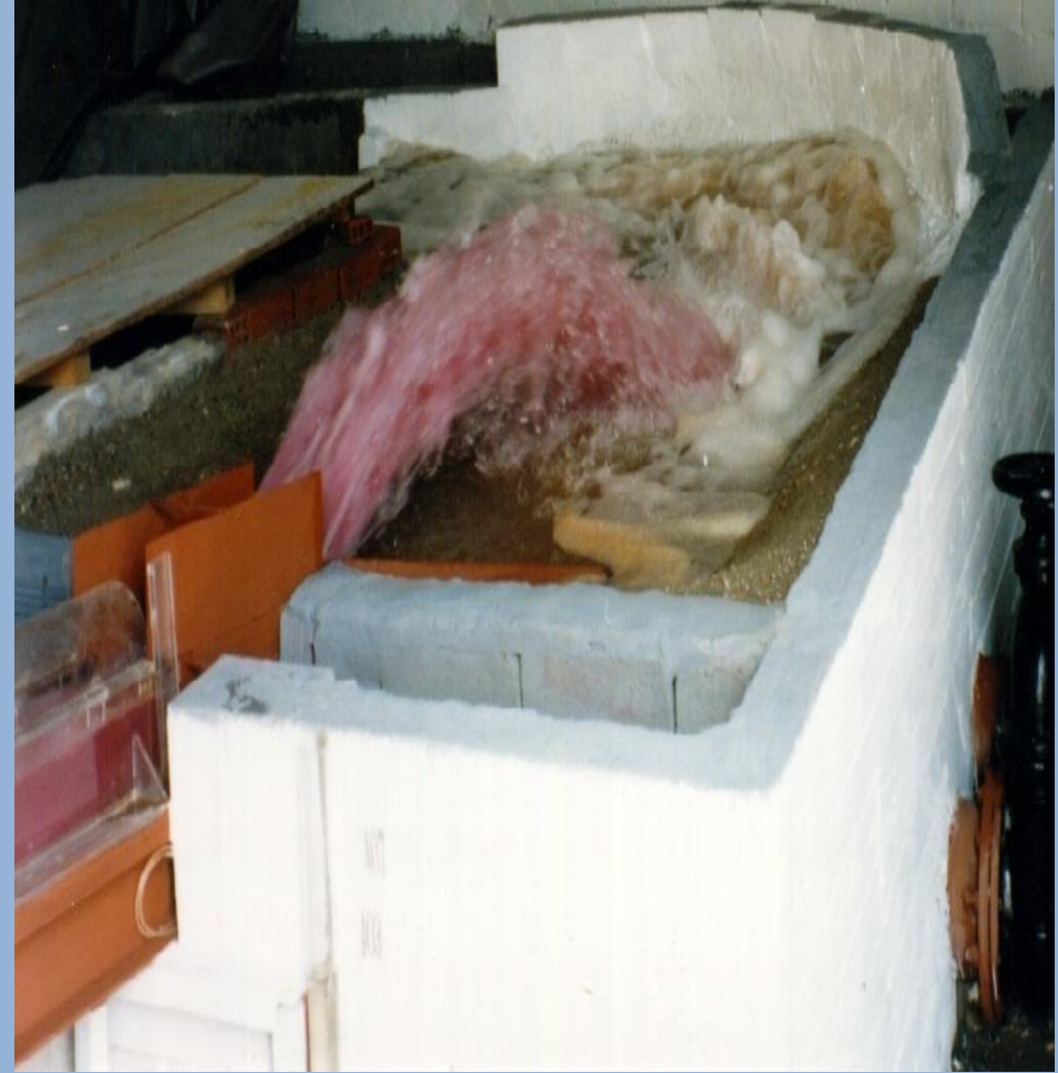
Διάταξη αναπήδησης του υδραυλικού ομοιώματος υπερχειλιστή Ευήνου
